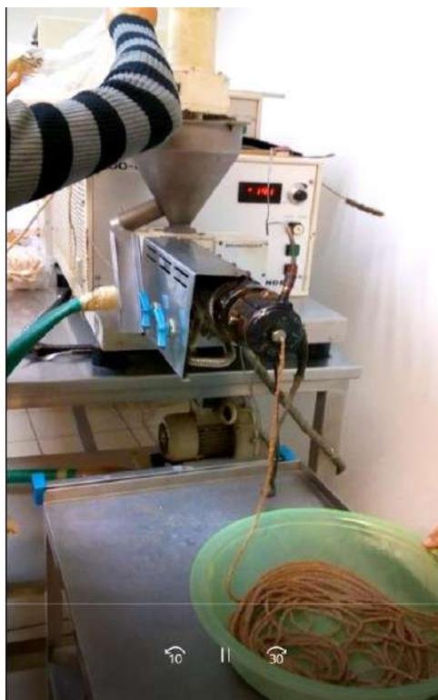
**Figura 5.** Proceso de extrusión de harina de semillas de yaca.
