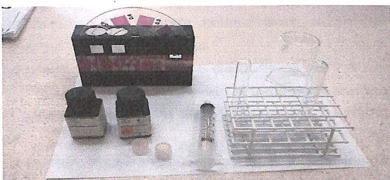
Figura 41. Material necesario para la determinación de cloro residual en agua.
