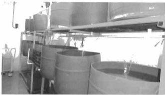
Figura 7. Sistema de recirculación utilizado en los ensayos de L. guttatus en sistemas de temperatura-salinidad.
